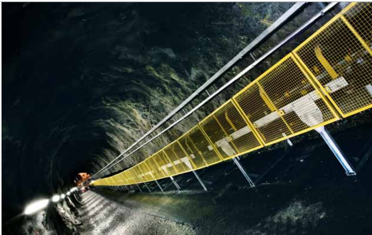
Nastro trasportatore delle materie prime, da cava a stabilimento, Robilante (CN) – Italia
